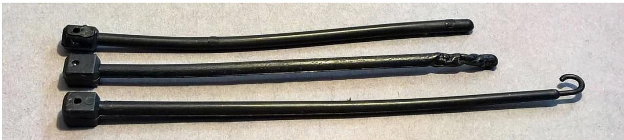
Abb. 12.02 Deichsel der Overland Stagecoach (unten) im Vergleich mit Deichseln der 1.ten (Mitte) und 2. ten Version (oben)
